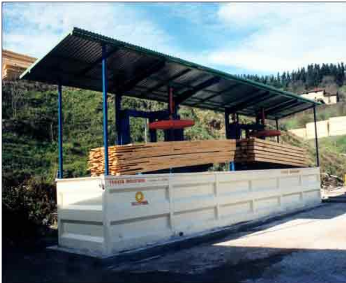
Cuba de tratamento por imersão. Anti Azulamento
